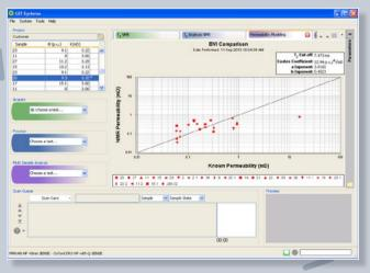
Figure 4 -- NMR permeability versus actual
