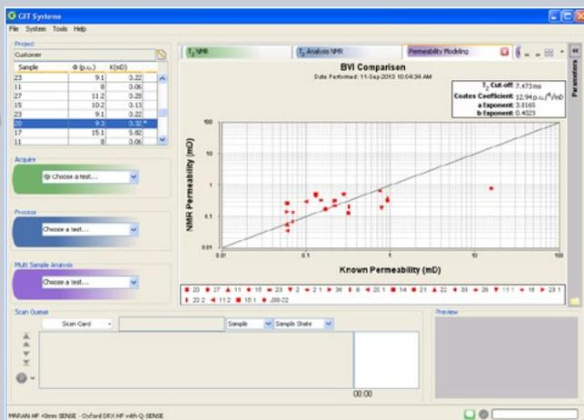
Figure 4 –NMR permeability versus actual
